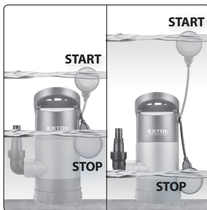
Obr.4, ilustrace funkce plovákového spínače
